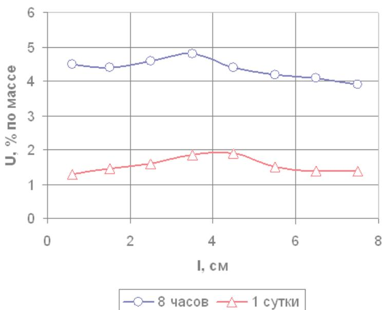
Рисунок 4. Распределение влагосодержания по длине образца ППМИ ( $\gamma=300$  кг/м<sup>3</sup>) в неизотермической разрезной колонке при температуре горячего конца 343К (70°C). Начальная средняя влажность образцов при установке в колонку 12% (по массе).
