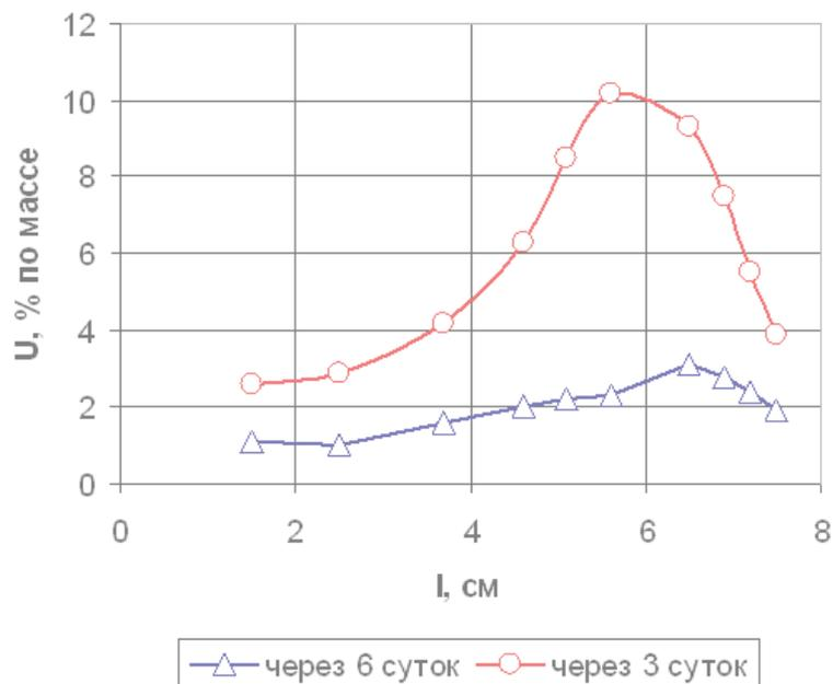
Рисунок 3. Распределение влагосодержания по длине образца ППМИ ( $\gamma=300$  кг/м<sup>3</sup>) в неизотермической разрезной колонке при температуре горячего конца 363К (90°C). Начальная средняя влажность образцов при установке в колонку 12% (по массе).
